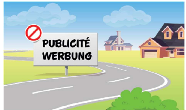
Endroits masquant la visibilité à l'intérieur d'un virage (OSR, art.96, al1, lettre a Norme VSS 40 090)
