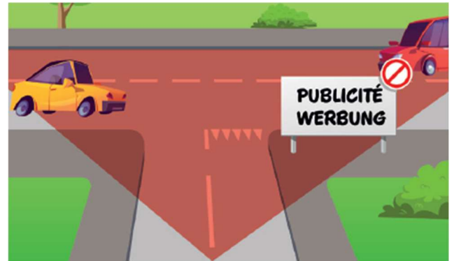
Endroits masquant la visibilité au débouché d’une route (OSR, art. 96, al. 1 et Norme VSS 40 273a)
