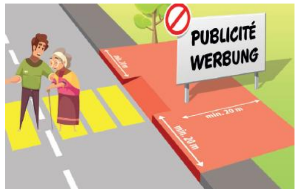
Erschwertes Erkennen von Fussgängern im Bereich von Fussgängerstreifen (SSV Art. 96, Abs 1, Bst. a ; VSS-Norm 40 241)
