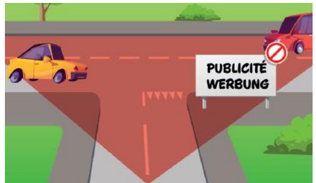
Standorte welche an Strassenverzweigung die Sichtweiten einschränken (SSV, Art. 96, Abs.1 und VSS-Norm 40 273)
