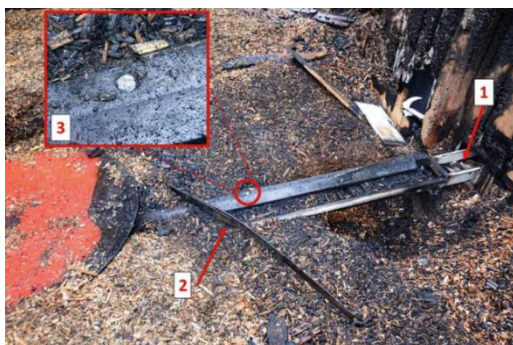
Du frottement ou des à-coups peuvent produire des étincelles et engendrer un incendie. Image d'une situation après un incendie : 1) À l'extérieur du bunker, les plaquettes de bois se trouvant dans le conduit de convoyage ne sont pas carbonisées. 2) Lame du racleur, qui frotte sur le sol. 3) Tête de vis, qui présente une usure manifeste. (Photo : IFS/Schallmoser*)
